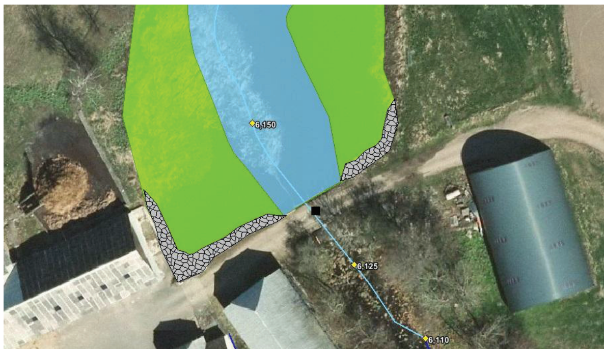
Figur 34 Stensikring af dæmning
